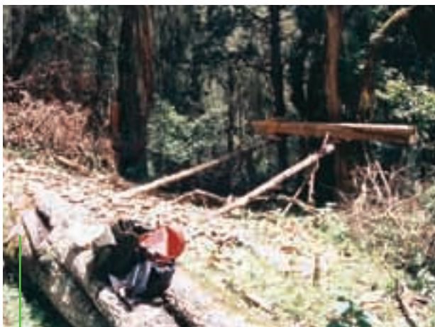
Hrubě osekáný hranol se vytáhne na lešení, rozřeže břichatkou na prkna a na nákladních zvířatech vyveze z lesa na trh
