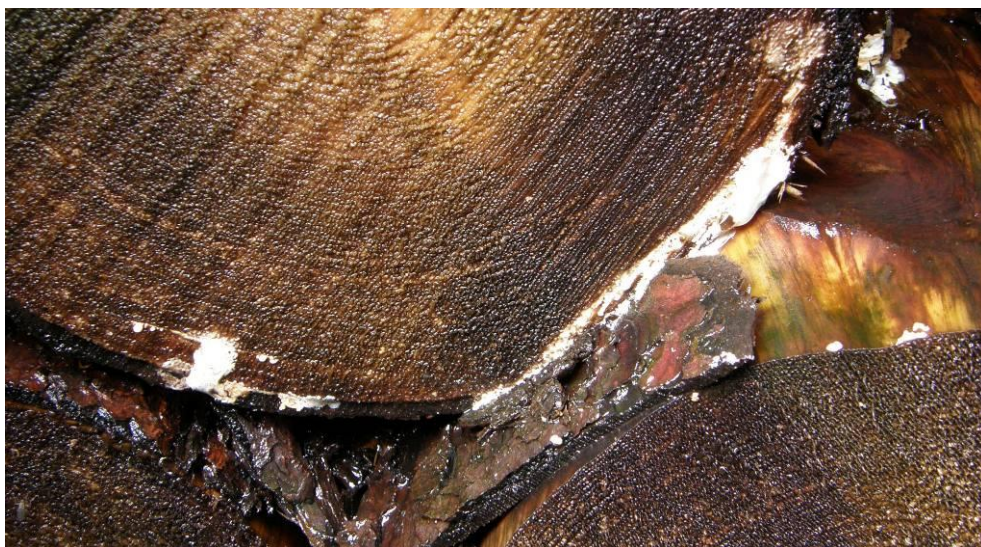
Obrázek č. 13: Začínající plíseň na obvodu čel výřezů bez ohledu na vlhkost.
