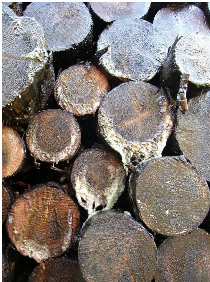
Obrázek č. 16 a): Výrony extraktivních látek z běli skladovaných výřezů.
