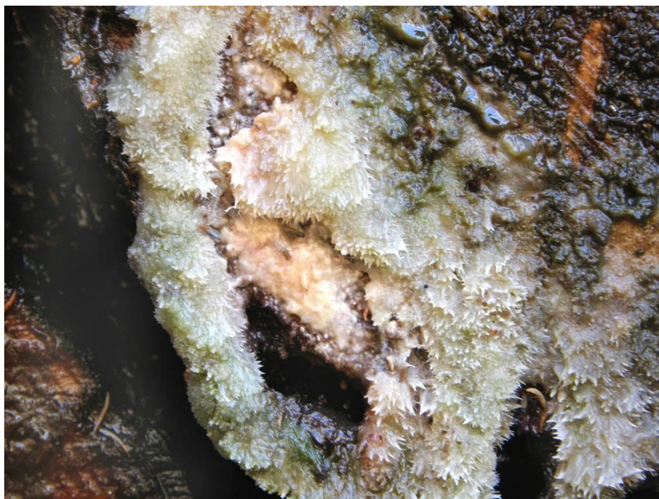
Obrázek č. 16 b): Výrony extraktivních látek z běli - detail.
