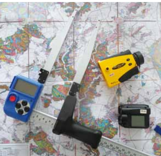
Pomůcky používané Lesy ČR při zjišťování zásob nastojato (průměrka Digitech Professional, výškoměr TruPulse 200B a výškoměr Vertex Laser 400). Foto: Jan Valenta
