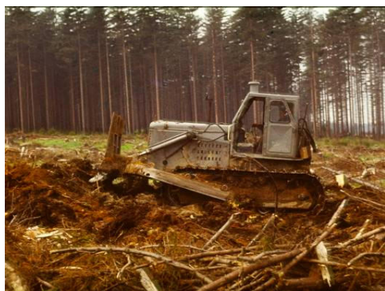
Obr. 1.3: Shrnování svrchních půdních vrstev buldozerem v 80. letech min. století
